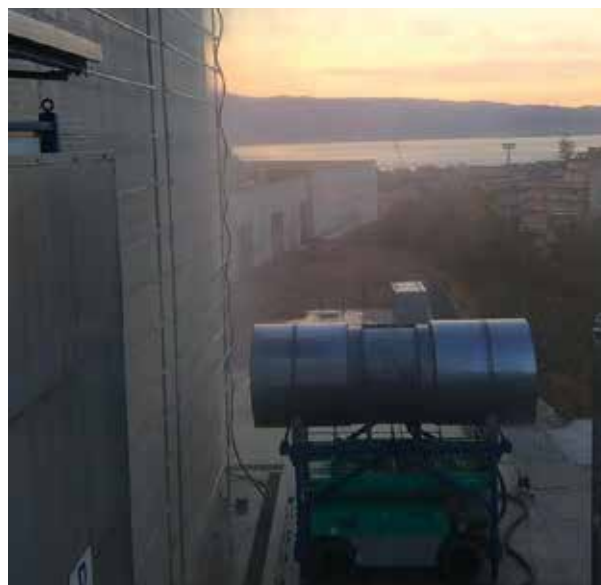
Figura 13 – Esecuzione di prova su mock-up di facciata (TCLab Envelope Testing, Università Mediterranea di Reggio Calabria).
