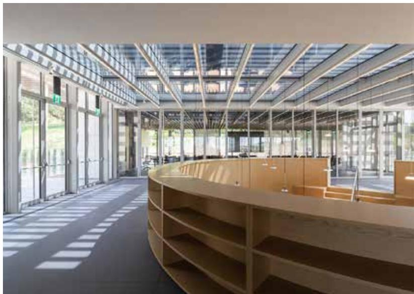
per la raccolta delle acque piovane. La copertura a lamelle frangisole regola l'ingresso della luce naturale, riducendo i consumi energetici e mantenendo una temperatura ottimale all'interno. Complessiva-
