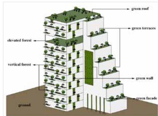
**Figura 01 – Possibili modalità di integrazione del verde nell'involucro edilizio (fonte: Wang, X., Gard, W., Borska, H. et al. Vertical greenery systems: from plants to trees with self-growing interconnections. Eur. J. Wood Prod. 78, 1031–1043 (2020))**
