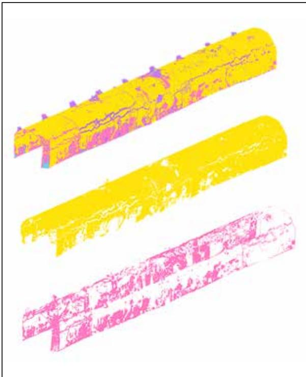
**Fig. 8 Dall'alto: segmentazione automatica di una porzione di nuvola di punti, estrazione delle aree soggette a umidità, estrazione delle aree soggette a patina biologica - Criptoportico del Parco Archeologico di Egnazia (Fasano - BR)**
