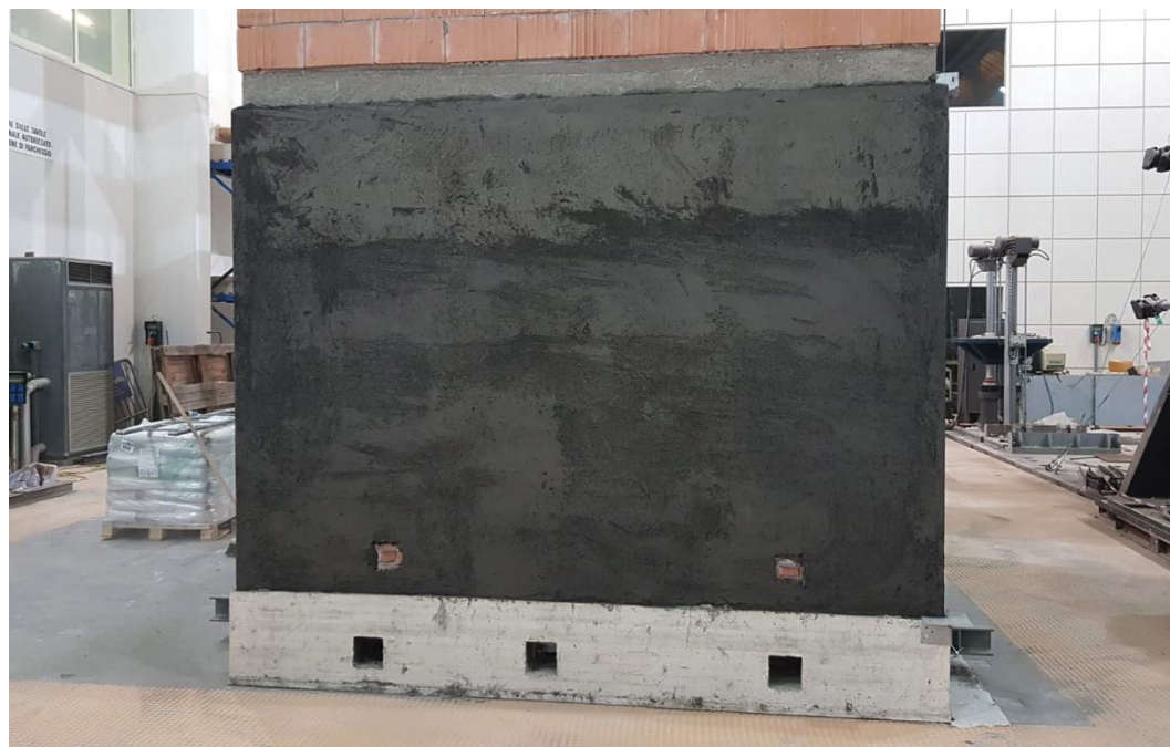
Figura 7. Posa in opera del sistema di rinforzo strutturale mediante malta MX-PVA Fibrorinforzata: immagini dei prospetti A-D (a) e C (b) dopo la seconda stesura.
