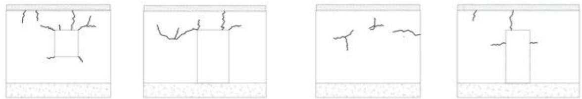
Figura 34 Configurazione danneggiata delle pareti interne del modello strutturale in muratura rinforzata mediante malta MX-PVA Fibrorinforzata.
