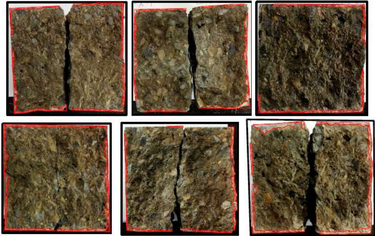
Figura 6. Provini realizzati con calcestruzzo additivato con Penetron Admix ® – prove di diffusione naturale dei cloruri – metodo del nitrato di argento
