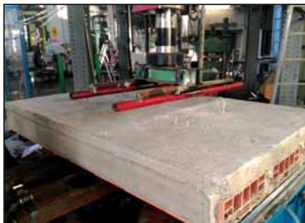
Figura 86: Allestimento del primo solaio di h 12 + 5 cm.
