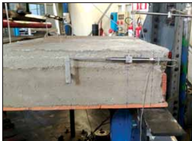
Figura 24: Strumenti per misurare lo scorrimento tra le due parti del solaio.
