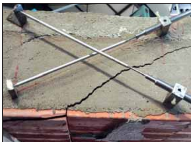
Figura 33: Rottura 2° solaio consolidato h = 12 + 5 \text{ cm} .
