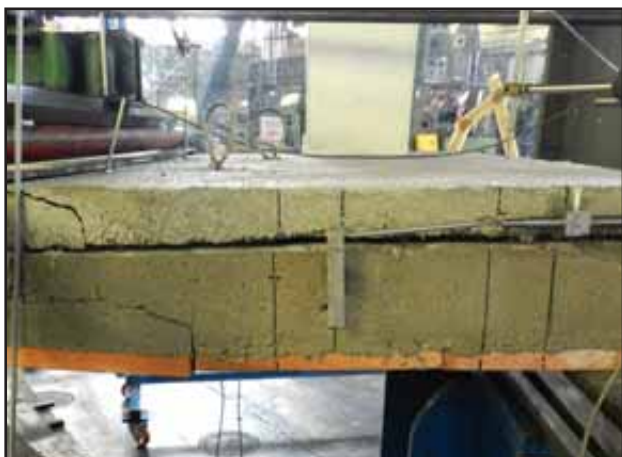
Figura 34: Rottura 1° solaio consolidato h = 12 + 5 cm.
