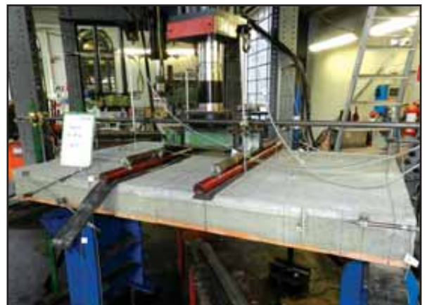
Figura 94: Allestimento del secondo solaio di h 16 + 5 cm.
