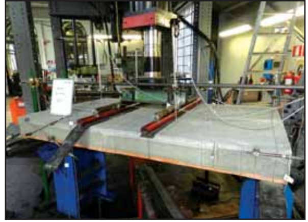
Figura 92: Allestimento del primo solaio di h 16 + 5 cm.
