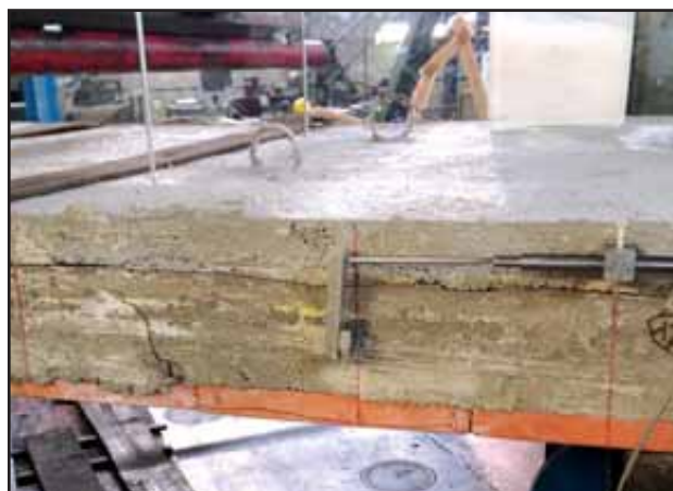
Figura 35: Rottura 2° solaio consolidato h=16 + 5 cm.
