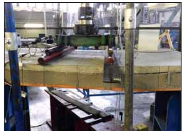
Figura 93: Rottura del primo solaio di h 12 + 5 cm.
