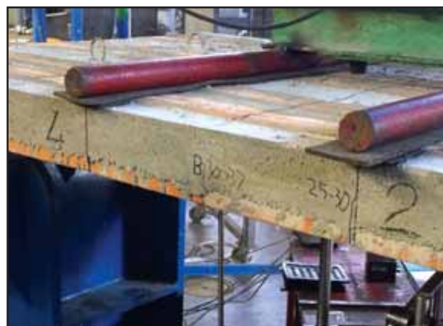
Figura 28: Rottura 1° solaio non consolidato h = 12 cm.
