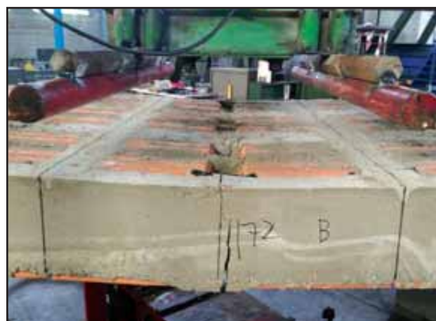
Figura 31: Rottura 2° solaio non consolidato h = 16 cm.
