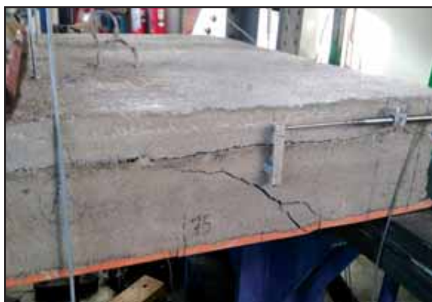
Figura 32: Rottura 1° solaio consolidato h = 12 + 5 \text{ cm} .
