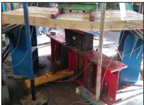
Figura 84: Rottura del secondo solaio di h 12 cm.
