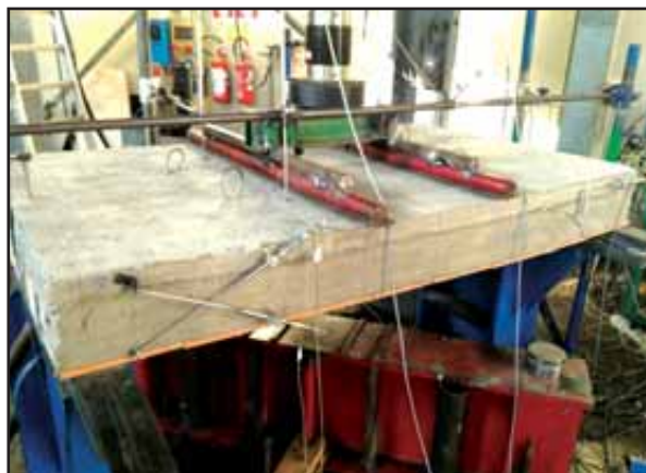
Figura 87: Rottura del primo solaio di h 12 + 5 cm.
