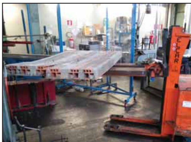
Figura 27: Carrello elevatore per disporre il solaio nella posizione corretta.
