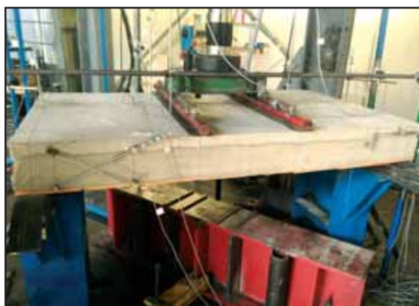
Figura 88: Allestimento del secondo solaio di h 12 + 5 cm.
