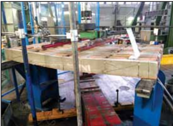
Figura 90: Rottura del secondo solaio di h 16 cm.
