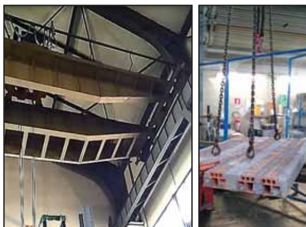
Figura 26: Carro ponte e ganci per sollevare il solaio.
