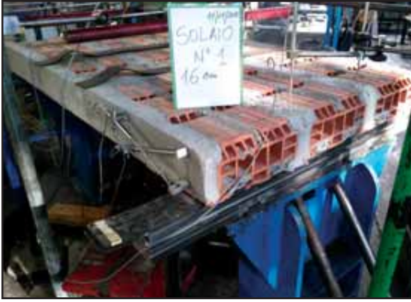
Figura 89: Allestimento del primo solaio di h 16 cm.
