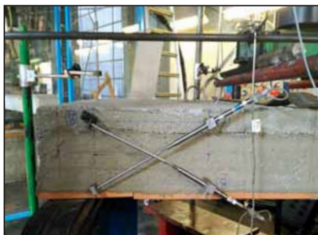
Figura 23: Strumenti per misurare le deformazioni a taglio.
