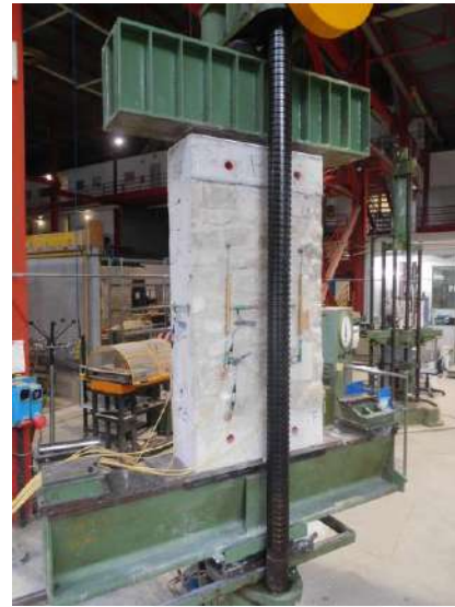
Figura 2: Prova di compressione verticale per la caratterizzazione dei provini murari.
