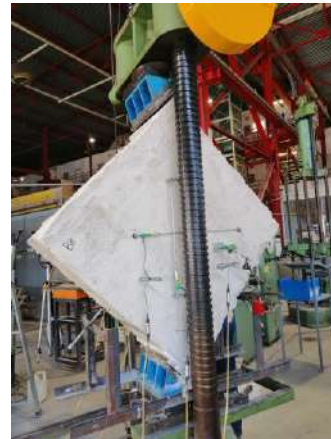
Figura 3: Prova di compressione diagonale per la caratterizzazione dei provini murari.
