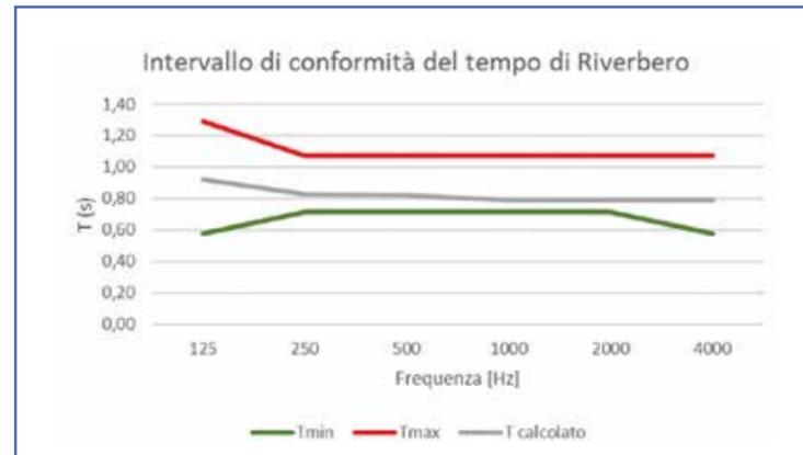
FIGURA 1 - INTERVALLO DI CONFORMITÀ DEL TEMPO DI RIVERBERO
