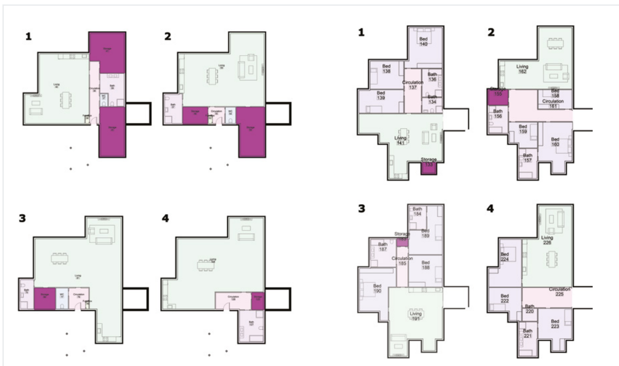
Diversi output di PlanFinder per il piano terra e il primo piano della AI House (fonte: Mohamed Elkazzaz)
