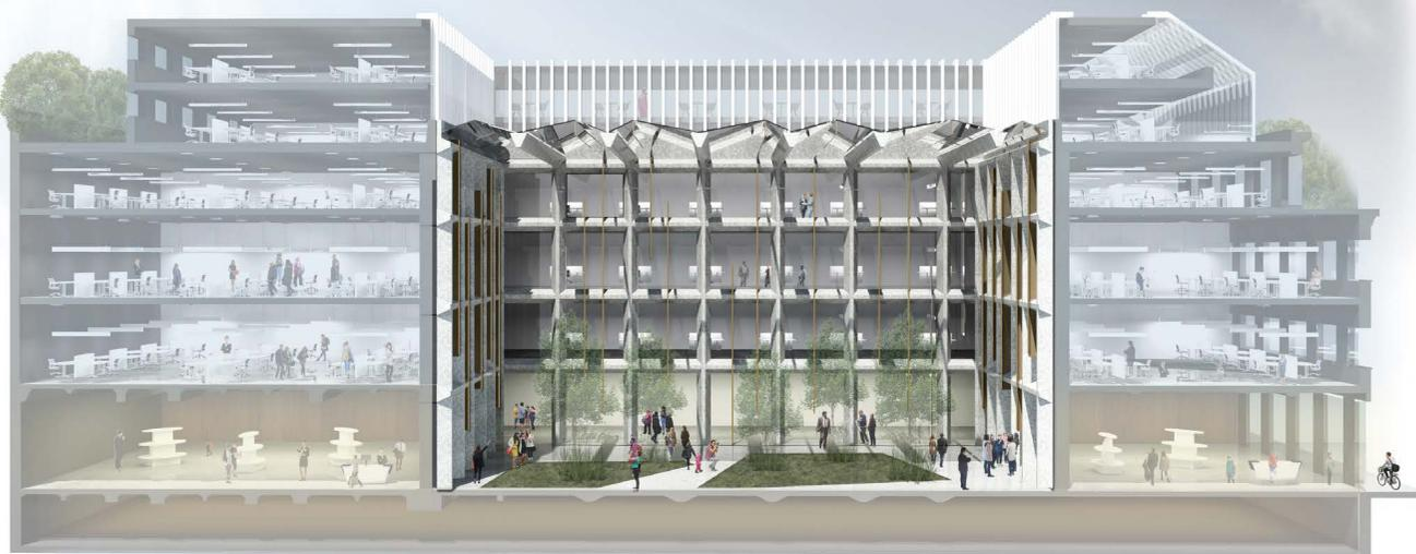
infatti invariata rispetto alla copertura originaria, che risale al 1904. Tramite questa nuova copertura è stato migliorato il filtraggio della luce naturale, e regolato il ricambio dell'aria, perché la struttura è dotata di meccanismi di apertura meccanizzata.
