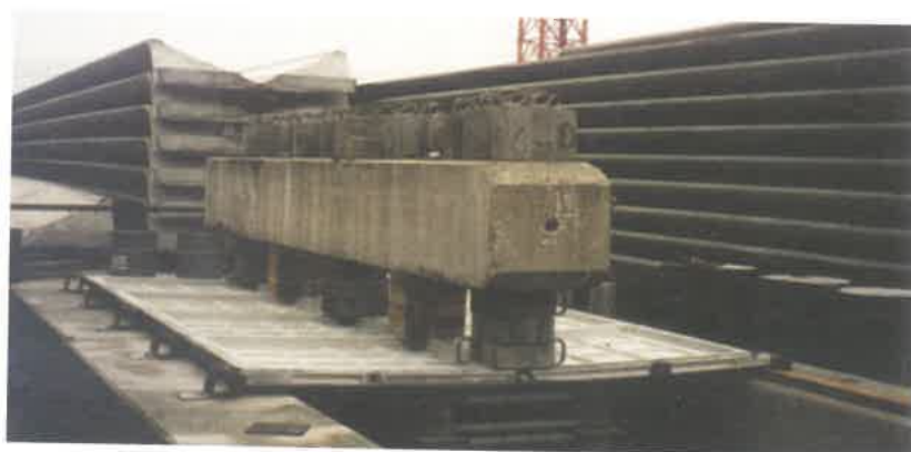
Prova di carico di cappel- le armate con fibra e con barre tradizionali nei tra- vetti. La fibra si rivela necessaria alla prova di pedonabilità.
