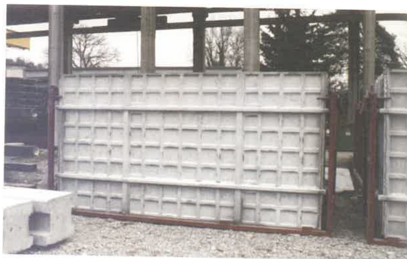
Coppella gettata in verticale, con armatura in fibre sintetiche con funzione di rete protettiva per gli spessori più ridotti
