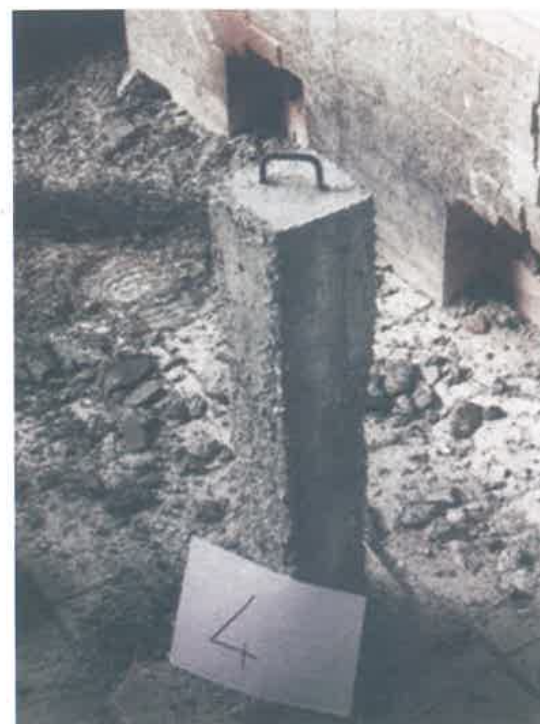
Provinci in C.A. con fibre sintetiche X FIBER 54 dosate a 2 kg/m³.
