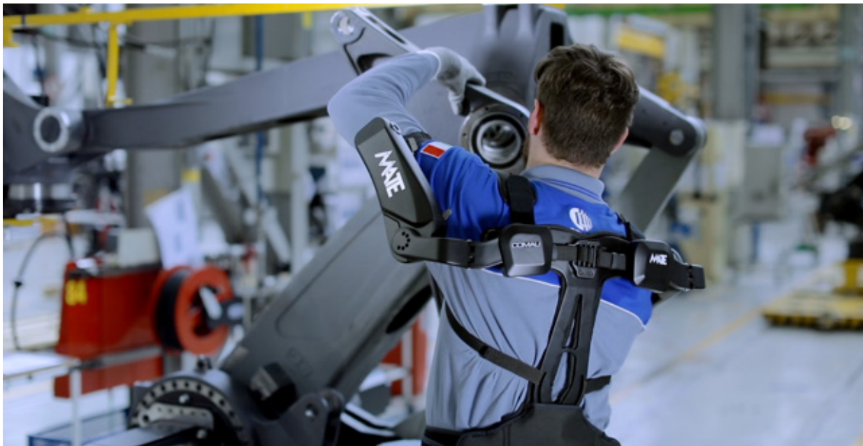
Mate, un esoscheletro pensato per l'industria automotive per facilitare le fasi lavorative che avvengono al di sotto della scocca delle automobili. Potrebbe presto trovare un posto anche nei cantieri edili
