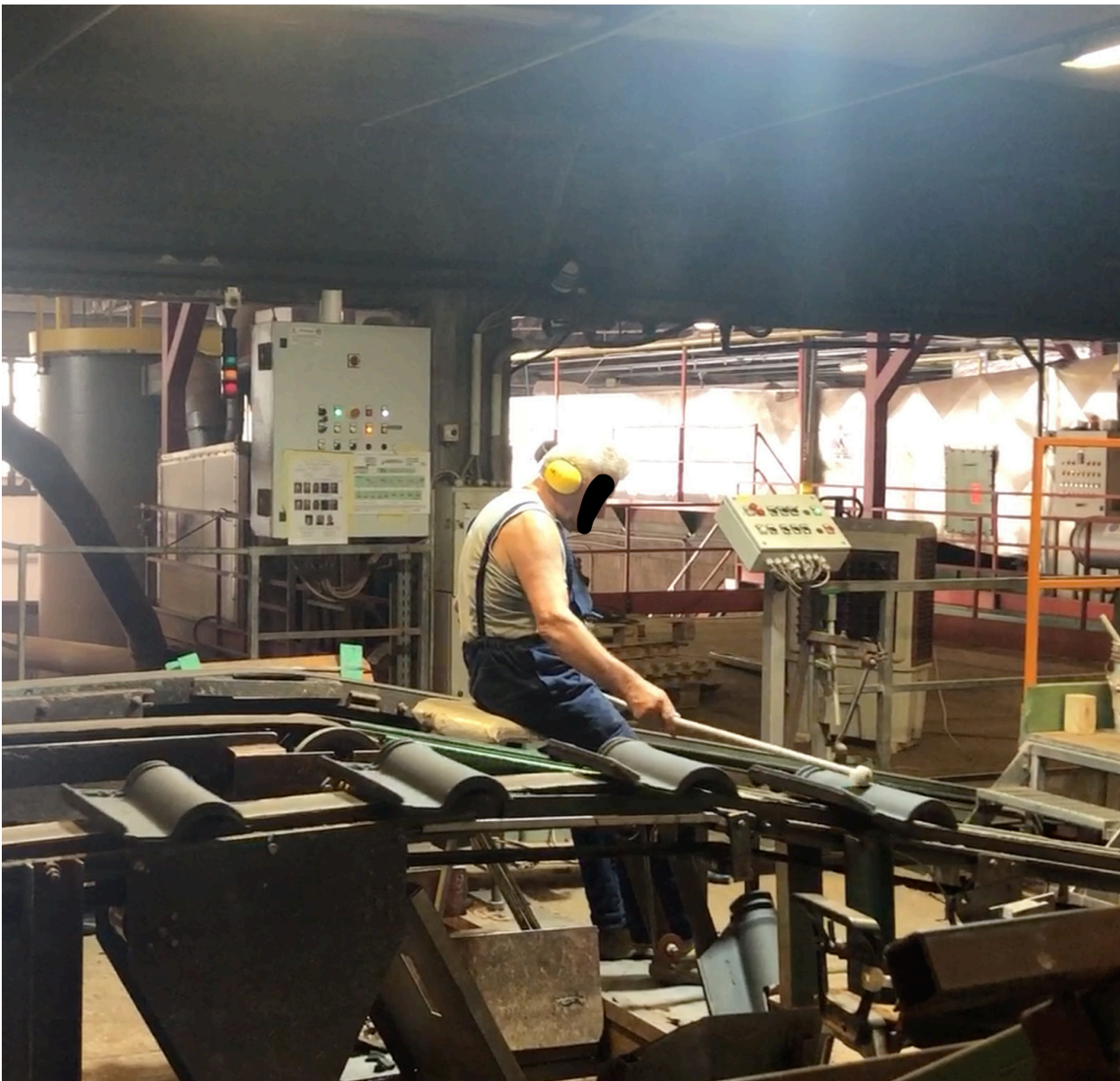
Per alcune mansioni pare gli esseri umani siano "insostituibili": un operaio testa le tegole uscite dal forno per individuare delle microfratture colpendole con un martelletto. Nonostante i tentativi non si è ancora riusciti a calibrare una macchina in modo sufficientemente preciso.
