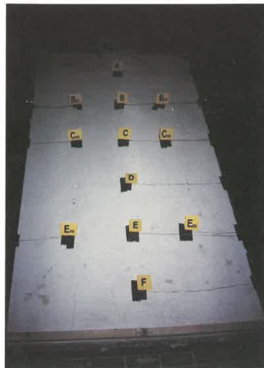
Posizione delle sonde per il rilievo delle temperature nel tetto. Nei punti del canale centrale le sonde sono state disposte in modo da rilevare le temperature ad ogni strato (sotto il solaio, tra solaio ed isolante, nel canale, e sulla superficie esterna), i flussi passanti e le velocità dell'aria nel condotto. Nei punti posti a lato le sonde sono state poste al fine di controllare gli eventuali effetti di bordo.
