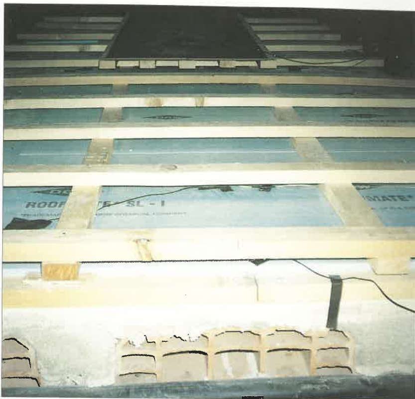
Vista della trancie di copertura realizzata in laboratorio. Si possono osservare i listelli di legno, posti sopra l'isolante, utilizzati per dare i diversi spessori alla camera di ventilazione
