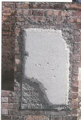
Intonaco traspirante applicato su una muratura di prova.
