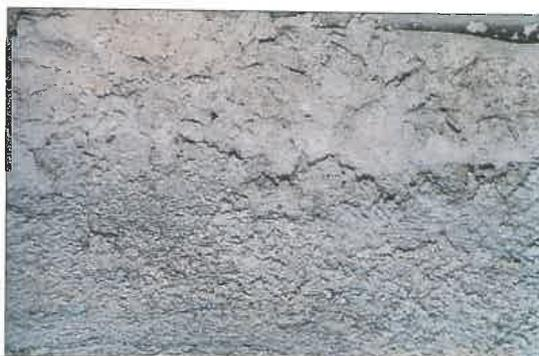
Il confronto tra un intonaco deumidificante e uno tradizionale dopo due anni di una prova di invecchiamento per aggressione salina dimostra la grande capacità degli intonaci deumidificanti di mantenersi integri.
