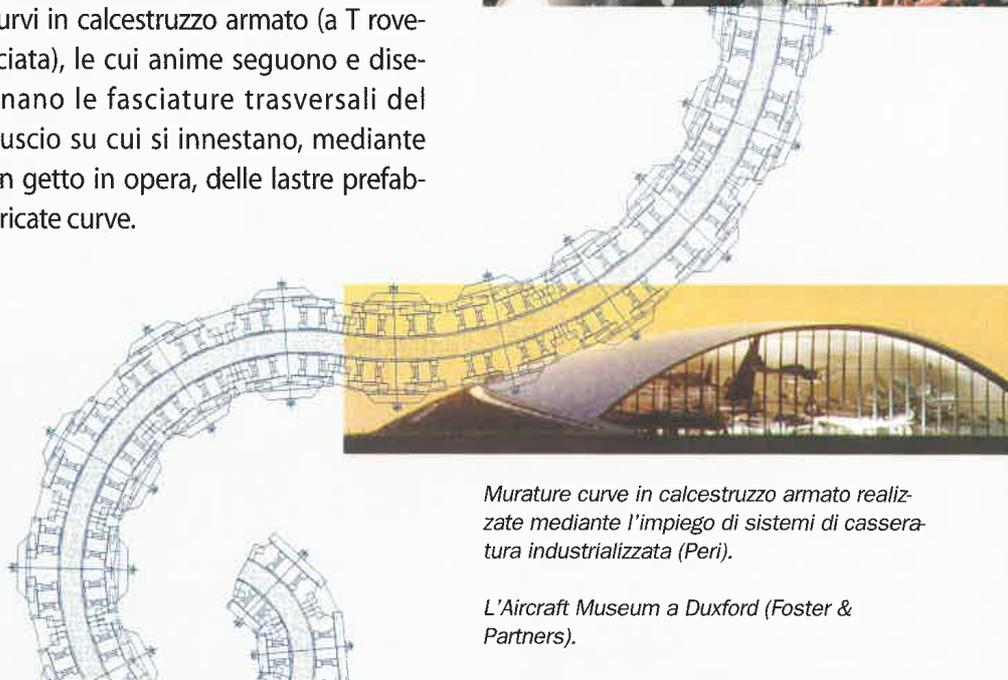
Murature curve in calcestruzzo armato realizzate mediante l'impiego di sistemi di cassera industrializzata (Peri).
