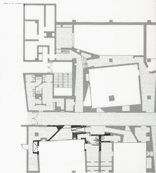
Sopra: in pianta i moduli di facciata incrementano la superficie delle aule e la dotazione di servizio integrando il sistema impiantistico esistente.
