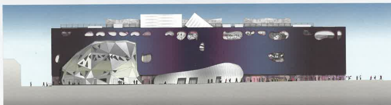
La struttura è composta da 13 coppie di pilastri in cemento a cui si ancorano, a sbalzo, gli elementi in acciaio che sostengono gli oggetti scultorei galleggianti.
