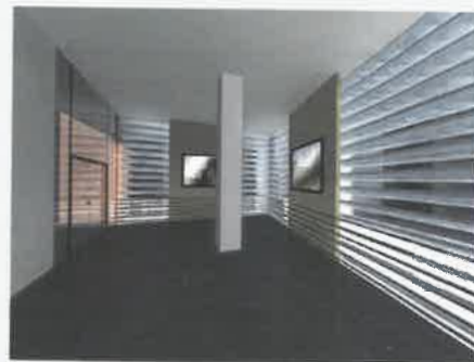
Technological Metallic Elements: progetto di un sistema di ombreggiamento e captazione per favorire la penetrazione della luce diffusa. Utile in una sala espositiva. (Progetto: Maiorca, Prassino, Terzoni, 2003).
