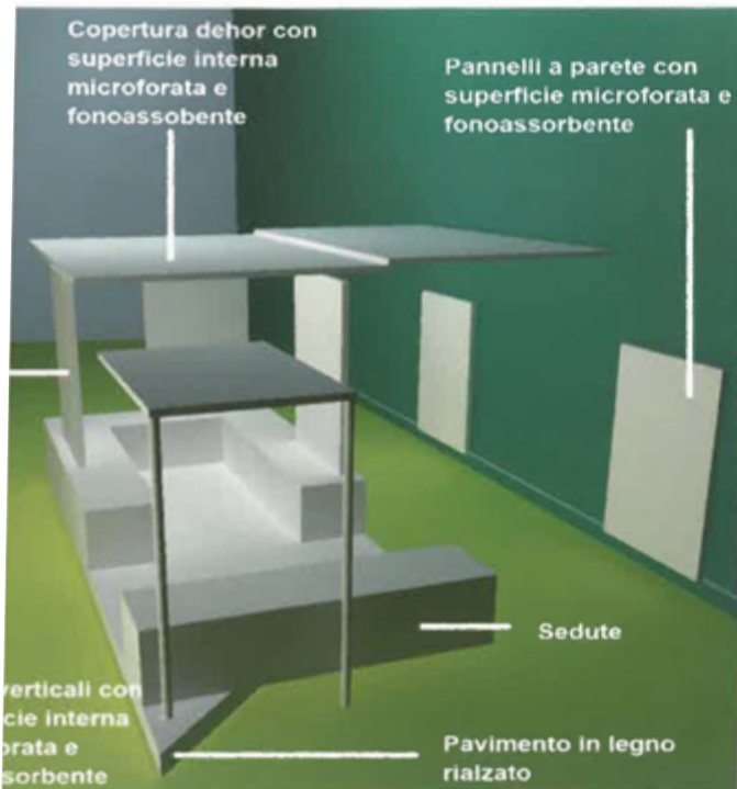
o del dehor acustico. Modello 3D e componenti.
