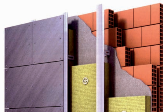
Sopra: esempio di sezione verticale tipo di facciata ventilata con rivestimento leggero (lastra composta sottile in lana di roccia ad alta densità). (Documentazione tecnica Rockwool Italia)
