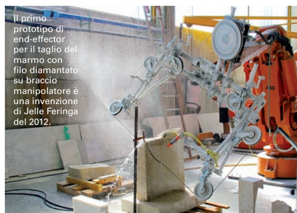
Gli esperimenti condotti da Jelle Feringa nel 2013 a Carrara hanno portato ad uno sviluppo industriale del processo di taglio robotico con filo diamantato.
