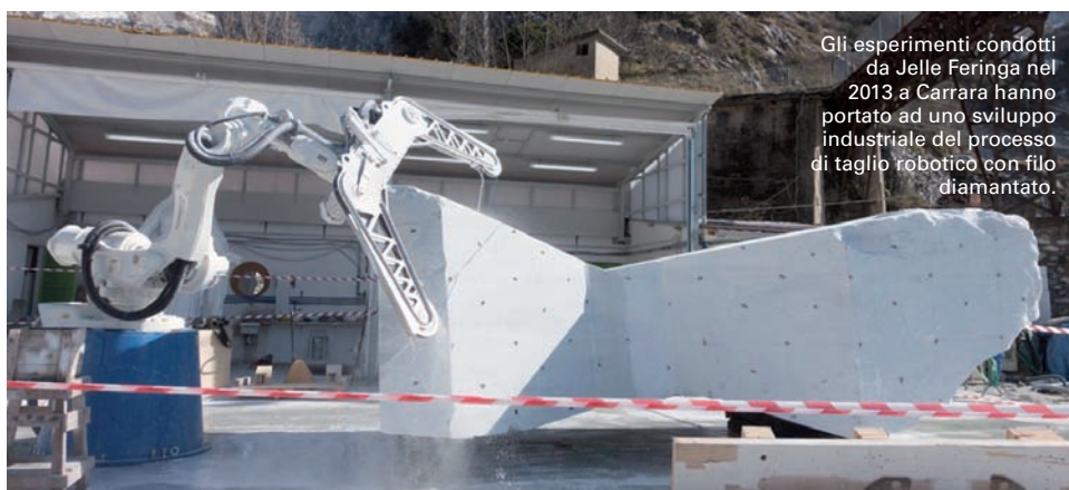
Il primo prototipo di end-effector per il taglio del marmo con filo diamantato su braccio manipolatore è una invenzione di Jelle Feringa del 2012.
