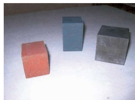
Pads di piccola dimensione, il colore indica densità differenti e quindi differenti capacità di carico (per cortese concessione di Consonica).
