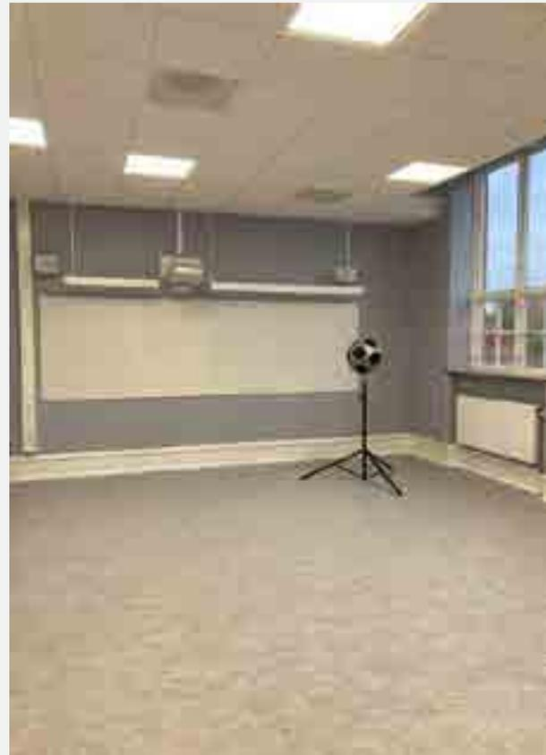
ti utilizzati i controsoffitti con sistema a ventilazione tradizionale (sinistra) sia nelle aule con ventilazione diffusa del controsoffitto (destra). Le misurazioni sono state effettuate in due delle quattro aule, in una con sistema a ventilazione diffusa a soffitto e nell'aula dotata di sistema di ventilazione tradizionale. Tutte le aule sono state trattate con un sistema fonoassorbente da 40 mm di spessore Ecophon e un sistema a parete fonoassorbente.
