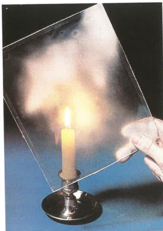
*Cristalli termocromici, si noti la reazione del "cloud Gel" alla variazione di temperatura.*
