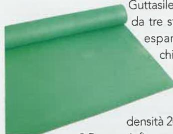
Guttasilent ecowall è una lastra formata da tre strati, uno strato di polietilene espanso a celle chiuse reticolato chimicamente con densità di 30 kg/m<sup>3</sup> di spessore di 3 mm accoppiato ad una lastra in gomma pesante (EPDM) di densità 2000 kg/m<sup>3</sup> con spessore di 2 o
