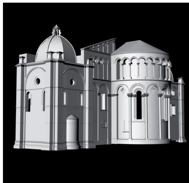
Sopra, modello 3d ottenuto con procedure di solid modeling dell'interno e degli esterni della zona absidale del Duomo di Lucca. A sinistra, mesh ricavata da nuvola di punti di una porzione dell'interno e dell'esterno dell'abside (Asastudio).
