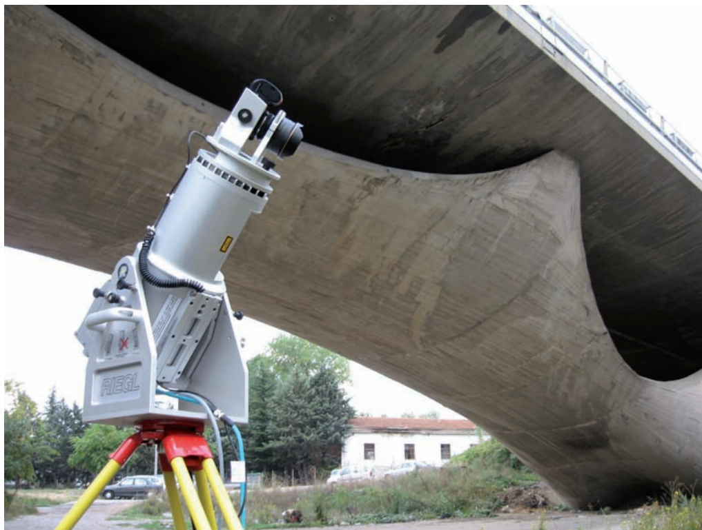
Momenti di ripresa scanner con strumento a tempo di volo (Asastudio).
