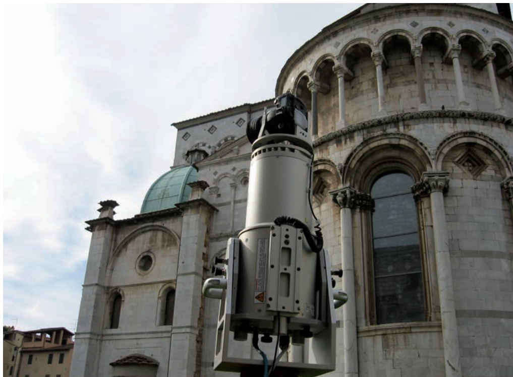
Scansione degli esterni del Duomo di Lucca con scanner laser a tempo di volo (Asastudio).
