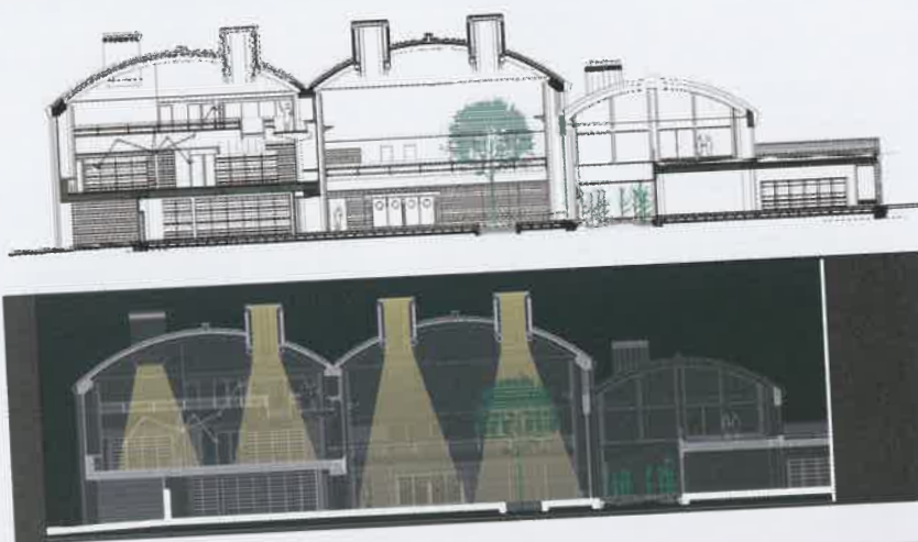
Sopra: veduta generale della biblioteca. In basso: sezioni trasversali veduta di dettaglio dei captatori eolici solari.
