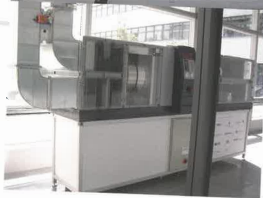
A sinistra, Fraunhofer Institute di Friburgo (Germania): prototipo di impianto a desiccant cooling.
