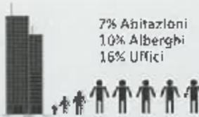
La Five Minute Handling Capacity (5MHC) è un indicatore della capacità del sistema di trasporto verticale di un gruppo di ascensori. La 5MHC indica la percentuale della popolazione totale dell'edificio che il sistema di ascensori è in grado di trasportare in un intervallo di 5 minuti.
