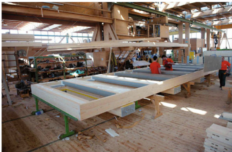
LifeCycle Tower One (Dornbirn, Austria): produzione di pannelli di facciata prefabbricati in stabilimento e movimentazione in cantiere per la posa in opera. Fonte: www.wooddays.eu 639 x 426
