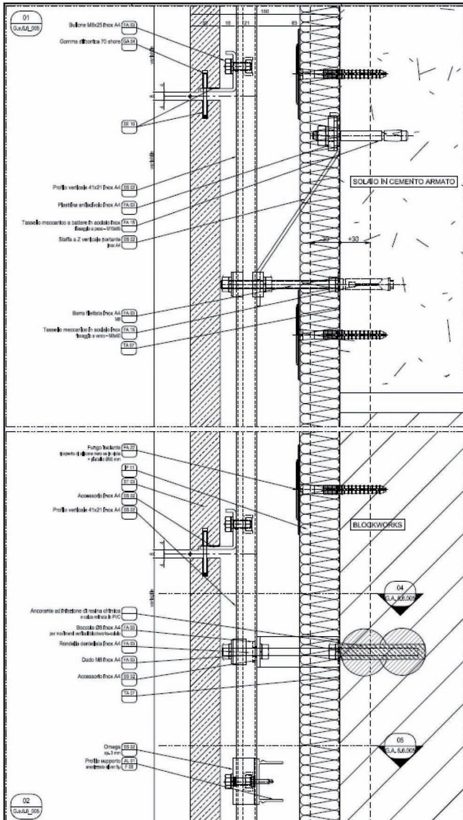
Sezione verticale di dettaglio con in evidenza i montanti collegati alla retrostante muratura in calcestruzzo per mezzo di tasselli meccanici. I montanti verticali portano le mensole di fissaggio delle lastre con kerf orizzontali (fonte Permasteelisa).
