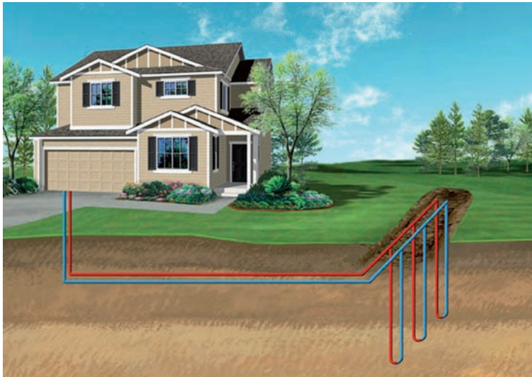
Impianto geotermico a sonde verticali.
