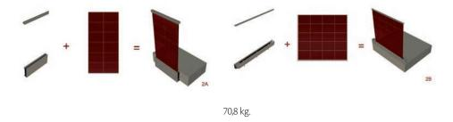
Il rendimento dell'oggetto architettonico parapetto varia da 40 Watt ad 80 Watt proporzionalmente al numero di moduli Dyepower utilizzati, dal loro livello di trasparenza e dalla loro colorazione. Nella tabella si riportano le caratteristiche relative alle quattro tipologie di installazioni sviluppate.
